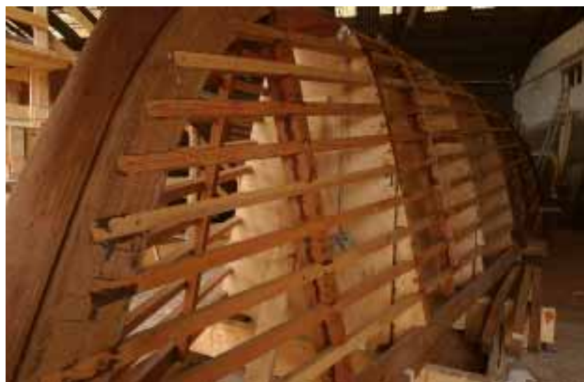
Figura 12 - Per permettere il corretto posizionamento della testa dei corsi di fasciame, sul dritto di prora viene preparato un apposito solco che va a costituire la battura delle classiche costruzioni in legno.
