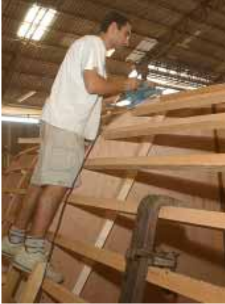
Figura 7 - Operazione di avviamento delle superfici su cui verrà posizionato il fasciame.
