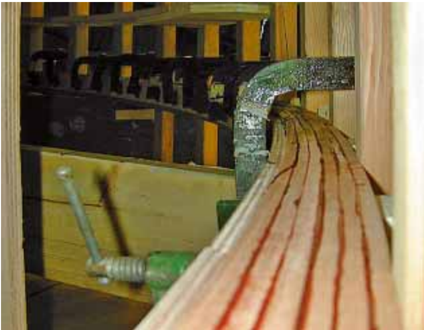
Figura 4 - La costruzione delle costole in lamellare consente una struttura monolitica in un sol pezzo nonostante la curvatura accentuata.
