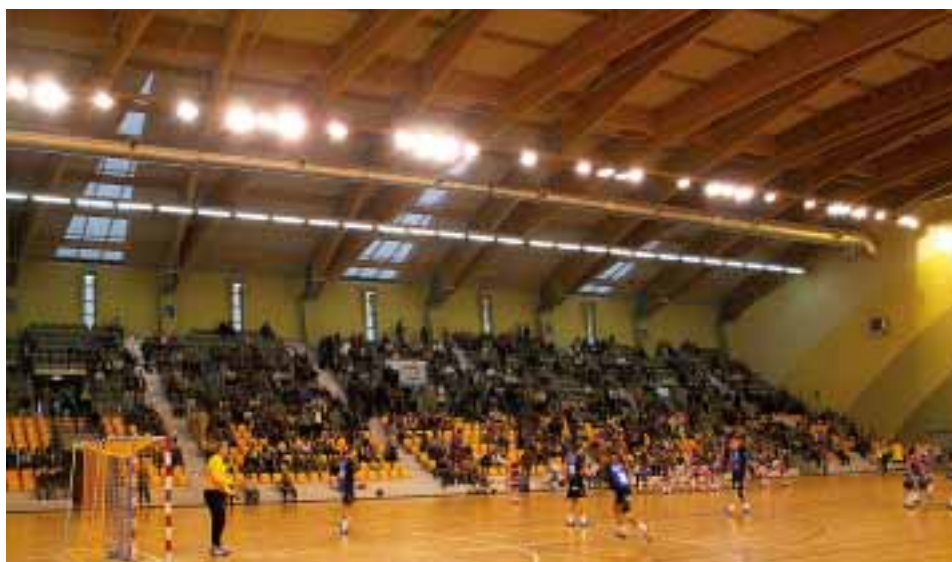
Figura 1 - Oggi il legno lamellare è un materiale usato sempre più di frequente, sia nel campo del diporto nautico che in altri campi, come quello dell'edilizia, dove con il lamellare si realizzano strutture anche importanti come interi palazzetti dello sport.
