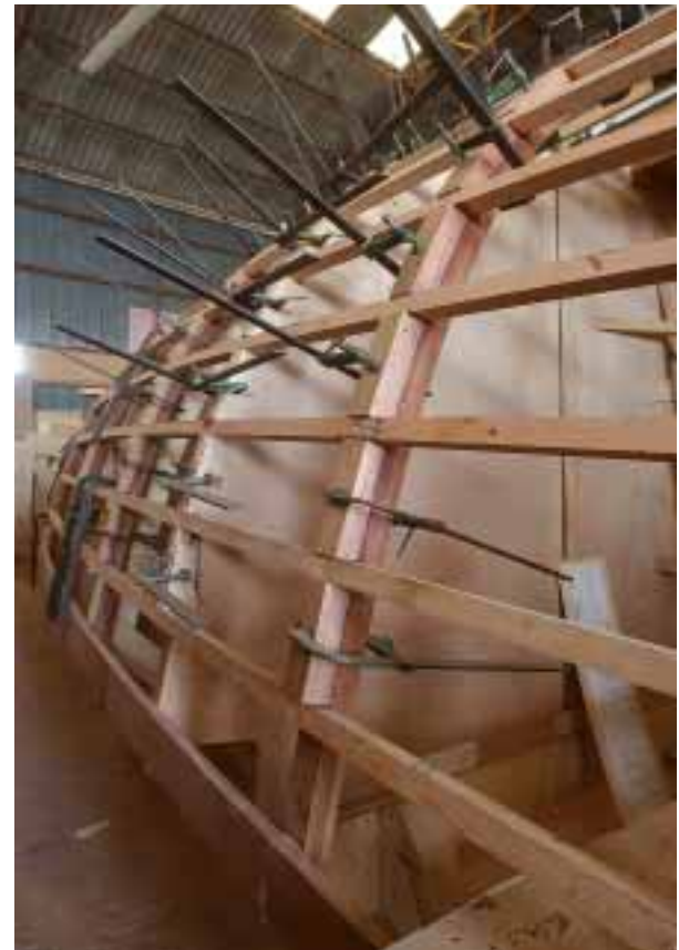
Figura 3 - Costruzione delle costole in un sol pezzo in lamellare direttamente in opera sulla forma dello scafo.
