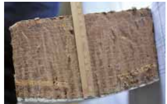
Figura 10 - Insetto della chiglia ricavato dall'alloggiamento del bow trust di prua. Si contano oltre 20 strati di lamellare fino a raggiungere lo spessore di 12 centimetri
