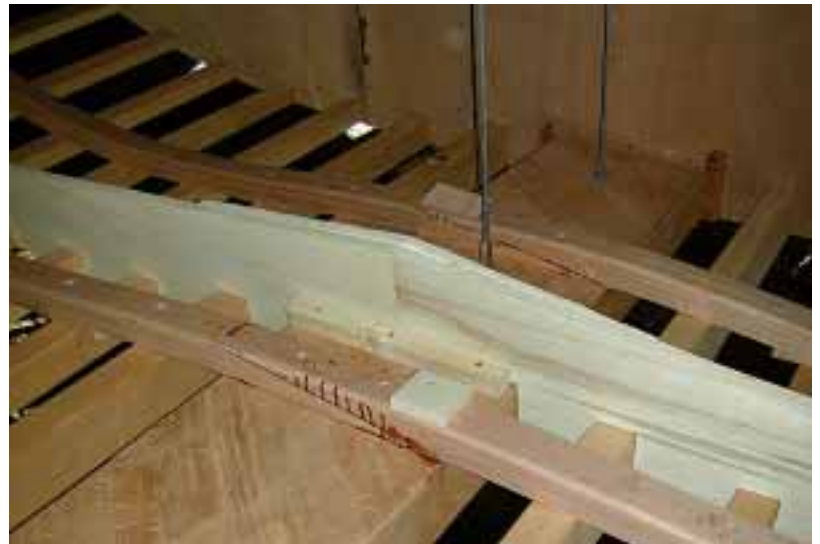
Figura 14 - I madieri sono realizzati concavi, in modo da accogliere la chiglia senza che questa sporga dalla superficie dello scafo.
