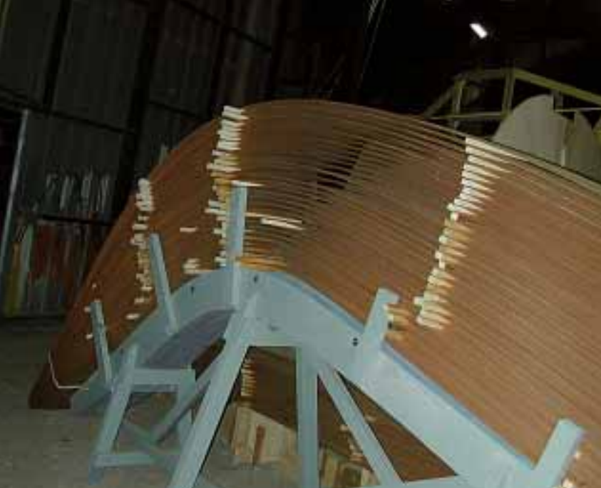
Figura 11 - Nella foto si vedono le lamelle costituenti la chiglia in posizione sullo stampo, prima dell'assemblaggio, mentre vengono arieggiate per avere la minima umidità possibile durante l'incollaggio.
