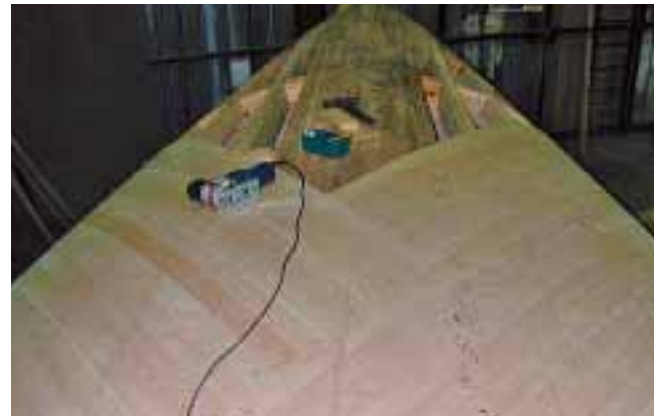
Figura 10 - Insetto della chiglia ricavato dall'alloggiamento del bow trust di prua. Si contano oltre 20 strati di lamellare fino a raggiungere lo spessore di 12 centimetri
