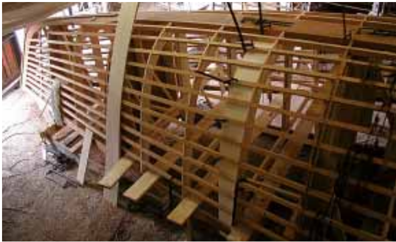
Figura 2 - La “cesta” o “gabbia”, cioè lo scheletro dell'imbarcazione, preparata disponendo le paratie e qualche ossatura provvisoria, sulle quali vediamo già posizionate la chiglia, la cinta, tradizionalmente la prima tavola della murata che appunto “cinge” longitudinalmente la barca nel punto della sua massima larghezza, e i correnti longitudinali posizionati con un intervallo di 20-25 centimetri.
