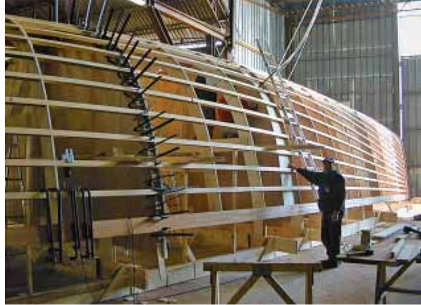
Figura 3 - Costruzione delle costole in un sol pezzo in lamellare direttamente in opera sulla forma dello scafo.
